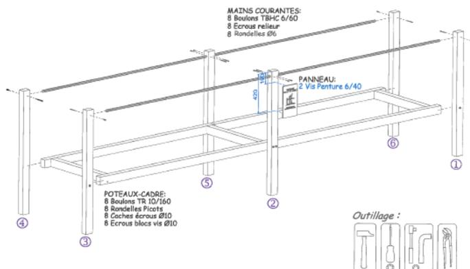
Pour le montage : sur chaque poteau il est indiqué : le nom de l'agrès et le numéro du pied. Rassemblez chaque poteaux et tubes par références ainsi que le sachet contenant la visserie (un par agrès). La logique de montage est la suivante : sens du poteau : toutes les vis qui indiquent le niveau zéro (le sol) doivent-être visible de l'extérieur.
