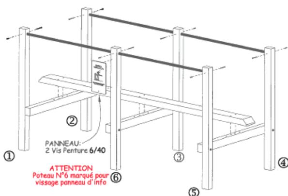
Ci-dessus poteaux avec leurs vis de repérage du niveau zéro. Exemple de montage : Poteau 1 face à vous, vis de niveau vers l'extérieur, poteau 2 en face, puis dans le sens horaire les poteaux 3 – 4 – 5 et 6. Tous nos parcours psychomoteurs respectent cette logique de montage. Les vis se mettent de l'intérieur vers l'extérieur sans oublier la rondelle anti-encrassement côté tête de vis, la rondelle en forme de cloche sert de rondelle pour l'écrou (serrer avec modération)
